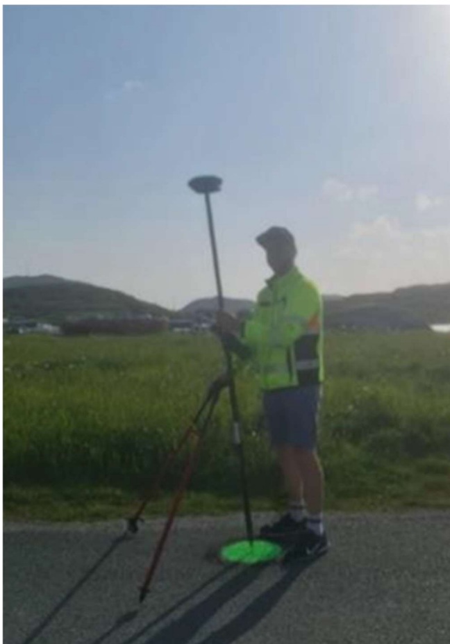
Figur 2: GPS-måling av kontrollpunkt. Kontrollpunkt malt med grønn og sort maling. Kilde: Scan Survey
