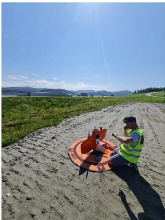
Figur 4: Det var denne dronen som ble brukt i dette prosjektet, en WingtraOne VTOL. Kilde: Scan Survey
