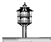
Medfjordbåen (59°20,1'N 10°34,3'E) (erstatte Bastøy fyr). 21,1 m høy lykt på betongsøyle, lysets høyde 11,0 moh.
