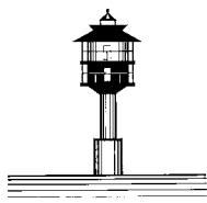
Hollenderbåen (59°09,6'N 10°37,4'E) (erstatte Fulehuk fyr). 29,8 m høy lykt på betongsøyle, lysets høyde 18,6 moh.
