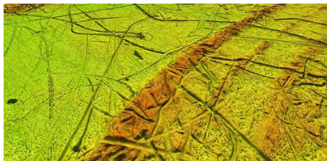
Bilde viser terrengmodell av havbunn i Barentshavet. Oppløsning 5 m. Havbunnen er preget av groper (pockmarks) og pløyemerker etter isfjell.
