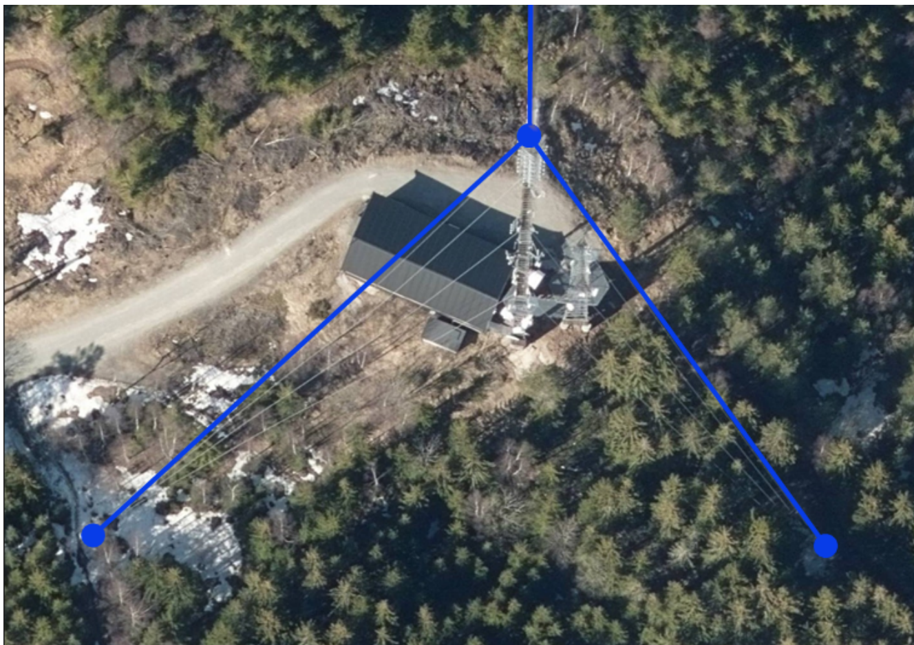
Figur 1. Illustrasjon av hvordan bardun skal registreres. Dersom flere barduner går i samme retning skal bare den høyeste og lengste bardunen registreres
